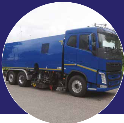
Bucher feiepåkbygg, 5-8m 3 beholder, og kundetilpasset (tidl. Beam) 9, 12 og 14 m 3 med opptil 7000 l vann, frontkost, bredsug, RotorClean osv.
