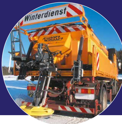
Küpper-Weisser spredde, tørrt/vått/slurry, Optiwet distribusjon, tallerken og/eller dyser, krok eller ben
