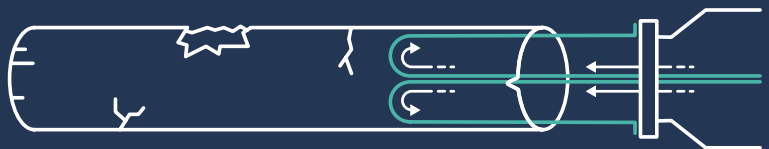
Fig.3 - Strømpeforingen vrenses inn i det eksisterende røret, dette gjøres ved hjelp av trykkluft fra en kompressor
