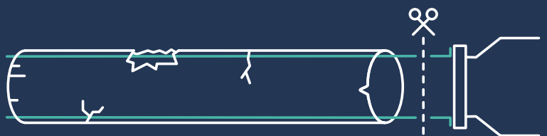
Fig.4 - Etter innblåsing herdes epoxyen med varmluft. Deretter kappes røret oppe og nede. Det er dette som utgjør den nye rørstammen, en fullverdig konstruksjon inne i det gamle røret
