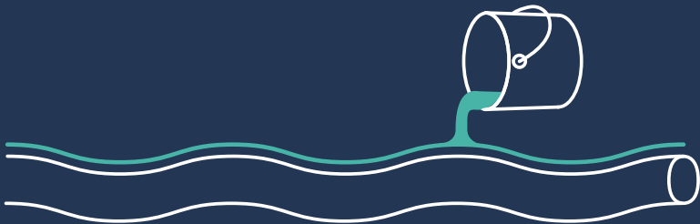
Fig.2 - En flexibel strømpeforing mettes med epoxy
